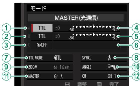
富士フィルムの光通信方式ワイヤレス多灯フラッシュシステムでは、マスターフラッシュとリモートフラッシュ間の光通信チャンネルをCH1～CH4から設定することができます。近隣で本フラッシュシステムを使用している場合の混信による誤動作を防いだり、複数のフラッシュシステムを使い分ける際に便利です。
