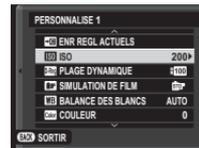
❖ Pour remplacer les réglages du jeu sélectionné par les réglages actuellement sélectionnés sur l'appareil photo, choisissez **ENR REGL ACTUELS** et appuyez sur **MENU/OK**.
