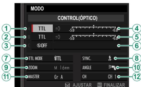
Las unidades maestra y remotas pueden colocarse en un máximo de tres grupos (A, B y C) y el modo del flash y el nivel del flash pueden ajustarse independientemente para cada grupo. Hay disponibles cuatro canales para la comunicación entre las unidades; podrán usarse distintos canales para diferentes sistemas de flash o para evitar interferencias al usar múltiples sistemas cerca.
