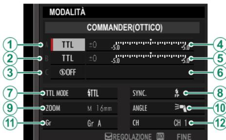
Il controllo flash remoto ottico wireless Fujifilm offre una scelta di quattro canali (canali da 1 a 4) per lo scambio di segnali ottici tra il commander e le unità flash remote. Canali separati possono essere utilizzati per sistemi flash diversi o per evitare interferenze quando più sistemi operano in stretta prossimità.
