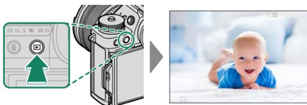
Drücken Sie die Auswahltaste nach links oder rechts oder drehen Sie das vordere Einstellrad, um weitere Bilder anzuzeigen. Durch Drücken der Auswahltaste oder Drehen des Einstellrads nach rechts werden die Bilder in der Aufnahmereihenfolge angezeigt, durch Drücken bzw. Drehen nach links in umgekehrter Reihenfolge. Halten Sie die Auswahltaste gedrückt, um schnell zum gewünschten Bild zu blättern.
