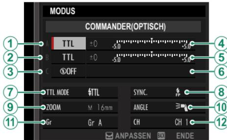
Die drahtlose optische Blitzfernsteuerung von Fujifilm bietet die Auswahl aus vier Kanälen (Kanäle 1 bis 4) für den Austausch der optischen Signale zwischen dem Master und den Slave-Blitzgeräten. Sie können getrennte Kanäle für verschiedene Blitzsysteme nutzen, um eine Beeinflussung zu vermeiden, wenn mehrere Systeme nah beieinander betrieben werden.
