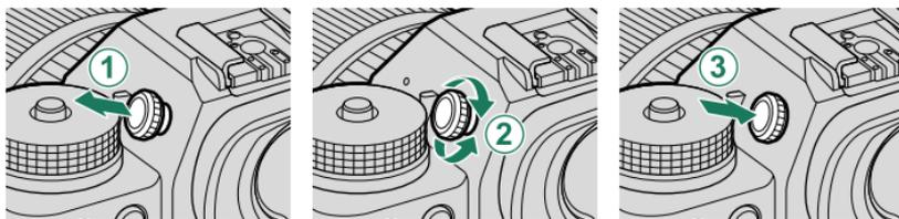
**!** Ziehen Sie das Bedienelement vor der Verwendung heraus. Anderenfalls kann dies zu einer Fehlfunktion des Produktes führen.
