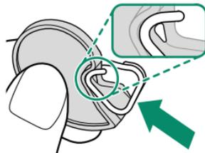
**4 Halten Sie die Trageriemenklammer an eine der Ösen.**
