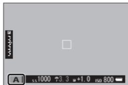
Wenn bei der gewählten Blende keine korrekte Belichtung erzielt werden kann, wird die Belichtungszeit rot angezeigt. Befindet sich die Motivhelligkeit außerhalb des Messbereichs der Kamera, erscheint „--“ in der Anzeige für die Belichtungszeit.
