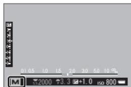
Bei anderen Einstellungszeiten als **180X** kann die Belichtungszeit in Schritten von  $\frac{1}{3}$  LW durch Drehen des hinteren Einstellrads eingestellt werden.
