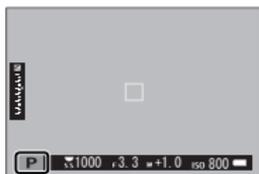
! Befindet sich die Motivhelligkeit außerhalb des Messbereichs der Kamera, erscheint „-- --“ in den Anzeigen für Belichtungszeit und Blende.
