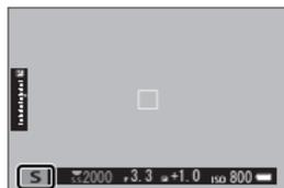
! Wenn mit der gewählten Belichtungszeit keine korrekte Belichtung erzielt werden kann, wird der Blendenwert rot angezeigt. Befindet sich die Motivhelligkeit außerhalb des Messbereichs der Kamera, erscheint „--“ in der Blendenanzeige.
