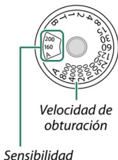
**!** Para elegir otra velocidad de obturación después de seleccionar **A** (automática), mantenga presionada la liberación del bloqueo del dial y gire el dial de velocidad de obturación.
