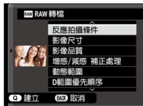
3 按下選擇器上方或下方反白顯示一個設定並按下選擇器右方顯示選項。按下選擇器上方或下方反白顯示所需選項，然後按下 **MENU/OK** 確認選擇並返回設定清單。重複該步驟可調整其他設定。
