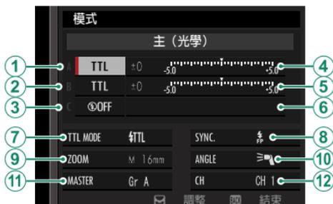
主閃光燈和遙控閃光燈組件最多可分為三組（A、B 和 C），每組的閃光燈模式和閃光級別可分別進行調整。有四個頻道可用於組件之間的通訊，不同的頻道可用於不同的閃光系統，或用於在近距離操作多個系統時防止干擾。
