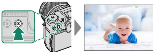
按下選擇器左方或右方或者旋轉前指令轉盤可檢視其他照片。按下選擇器右方或向右旋轉轉盤可按拍攝順序檢視照片，按下左方或向左旋轉則按相反順序檢視照片。按住選擇器可快速捲動至您所需的照片。
