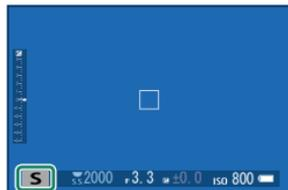
❗ 若在所選快門速度下無法獲得正確的曝光，光圈將顯示為紅色。若拍攝對象位於相機測光範圍之外，光圈將顯示為“---”。
