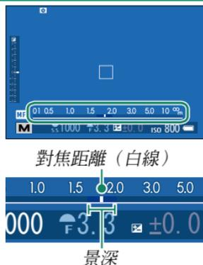
若在 **畫面設定 > 顯示自訂設定** 清單中同時選擇了 **AF 距離指示** 和 **MF 距離指示**，使用標準顯示中的景深指示也可檢視手動對焦指示。使用 **DISP/BACK** 鈕可顯示標準指示。
