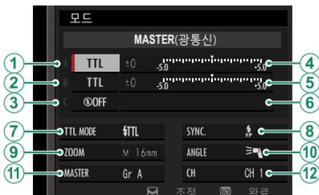
최대 3개 그룹(A, B, C)까지 마스터 및 원격 장치를 배치할 수 있으며 각 그룹에 대해 플래시 모드와 플래시 광량을 별도로 조정할 수 있습니다. 장치 간 통신을 위해 4개 채널을 사용할 수 있습니다. 다른 플래시 시스템에서 사용하거나 여러 시스템이 가까이에서 작동 중일 때 간섭을 피하기 위해 별도의 채널을 사용할 수 있습니다.
