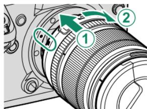
❗ 렌즈를 장착할 때 먼지나 기타 이물질이 카메라에 들어가지 않도록 하며 카메라 내부 부품을 건드리지 않도록 주의합니다. 렌즈를 부착할 때 렌즈 분리 버튼을 누르지 않도록 주의하고 래치가 단단히 고정되었는지 확인하십시오.
