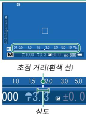
**화면 설정 > 사용자 설정 표시** 목록에서 **AF 거리 표시기**와 **MF 거리 표시기**를 모두 선택하면 표준 디스플레이의 피사계 심도 표시기를 사용하여 수동 초점 표시기를 볼 수도 있습니다. **DISP/BACK** 버튼을 사용하여 표준 표시기를 표시합니다.
