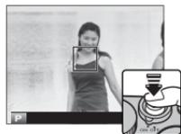
Il est également possible de verrouiller la mise au point et l'exposition respectivement avec les touches **AF-L** et **AE-L**, (si **AE/AF SEUL** est sélectionné pour **TOUCHE MEM. AF** du menu de prise de vue, la pression de la touche **AF-L** verrouillera à la fois la mise au point et l'exposition ; 95).
