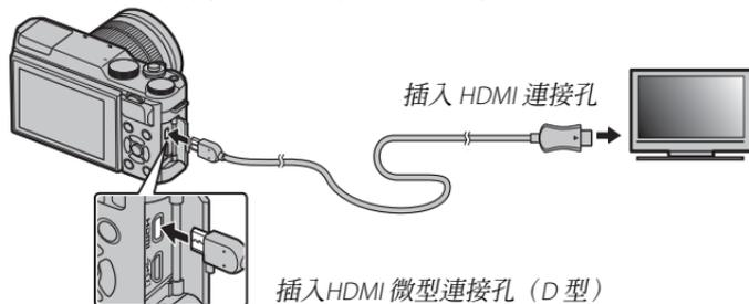
① 請使用具備 D 型（HDMI 微型）插頭且不超過 1.5m 長的 HDMI 線組以連接至相機。
