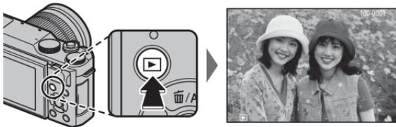
按下選擇器左方或右方或者旋轉主指令轉盤可檢視其他照片。按下選擇器右方或向右旋轉轉盤可按拍攝順序檢視照片，按下左方或向左旋轉則按相反順序檢視照片。按住選擇器可快速捲動至您所需的照片。
