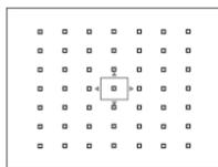
若要選擇對焦框的尺寸，請按下選擇器上方（**AF**）並旋轉副指令轉盤。向左旋轉轉盤可將對焦框最多縮小至 50%，向右旋轉可最多放大至 150%，按下轉盤的中央則可將對焦框還原至原始尺寸。按下 **MENU/OK** 可使設定生效。
