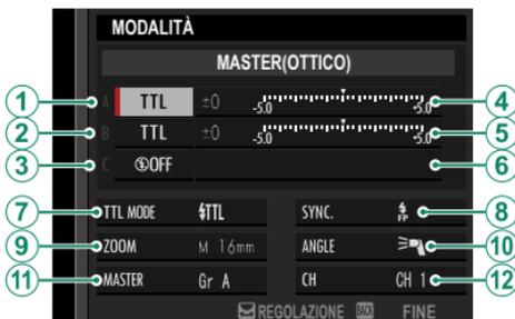
Le unità master e quelle remote possono essere collocate in tre gruppi al massimo (A, B e C) e la modalità flash e il livello flash possono essere regolati separatamente per ciascun gruppo. Quattro canali sono disponibili per la comunicazione tra le unità; canali separati possono essere utilizzati per sistemi flash diversi o per evitare interferenze quando più sistemi operano in stretta prossimità.
