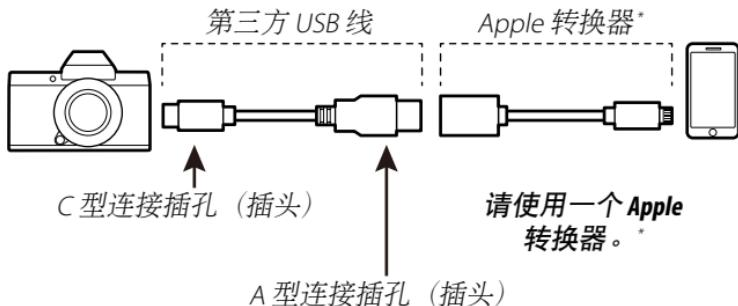
\* 请使用一个 Apple 闪电转 USB 相机转换器或闪电转 USB 3 相机转换器。
