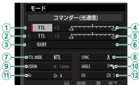
富士フィルムの光通信方式ワイヤレス多灯フラッシュシステムでは、コマンダーフラッシュとリモートフラッシュ間の光通信チャンネルをCH1～CH4から設定することができます。近隣で本フラッシュシステムを使用している場合の混信による誤動作を防いだり、複数のフラッシュシステムを使い分ける際に便利です。
