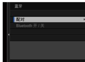
4 在智能手机上启动应用程序并使智能手机与相机配对，以在智能手机和相机上显示一个代码。确认这两个代码匹配以进行配对。
