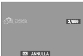
La ripresa a intervalli con timer non può essere utilizzata con tempi di posa di "bulb" (posa B) o con la fotografia di esposizioni multiple. In modalità burst, viene scattata una sola foto a ogni pressione del pulsante di scatto.
