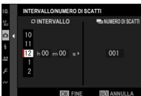
Se si utilizza un telecomando per scatto a distanza con il proprio timer, selezionare **CON TIMER ESTERNO**. Si tornerà alla visualizzazione di ripresa, in cui è possibile avviare le foto intervallate utilizzando il telecomando per scatto a distanza.
