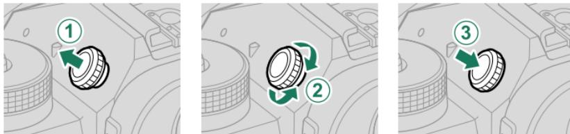
**!** Levante el control antes del uso. Si se hace caso omiso de esta precaución, puede producirse un funcionamiento erróneo.
