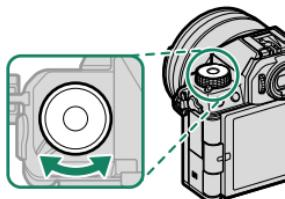
Al salir de fábrica, el dial tiene asignada la función **PREDETERMIN.** Con este ajuste, la función del dial varía según la posición del dial de modo.
