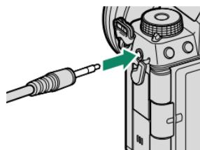
**!** Si conecta un disparador remoto, se visualizará un cuadro de diálogo de confirmación mientras el dial de modo se gira hacia **REC** (vídeo) o **Vlog**; pulse **MENU/OK** y seleccione **REMOTO** para **MIC./DISP. REMOTO**.
