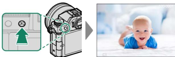
Podrá visualizar imágenes adicionales pulsando el mando de enfoque (palanca de enfoque) hacia la izquierda o hacia la derecha o girando el dial de control delantero. Pulse el mando de enfoque o gire el dial hacia la derecha para ver las imágenes en el orden en que se grabaron y hacia la izquierda para verlas en el orden inverso. Mantenga el mando de enfoque pulsado para desplazarse rápidamente a la foto deseada.
