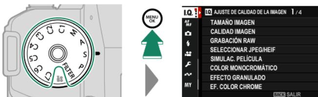
En los modos de **C1** a **C7**, los menús de las fotos se mostrarán si **FOTO** es seleccionado para el banco elegido usando **AJUSTE DE CALIDAD DE LA IMAGEN** > **AJUSTE DE MODO PERSONALIZADO** en los menús de las fotos o **AJUSTE DE LA PELÍCULA** > **AJUSTE DE MODO PERSONALIZADO** en los menús de los vídeos (64).
