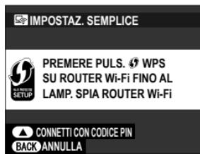
È inoltre presente l'opzione di eseguire la connessione utilizzando un PIN. Visualizzare il PIN della fotocamera premendo la leva di messa a fuoco verso l'alto e inserirlo sul router LAN wireless.
