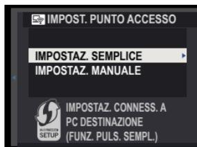
Per selezionare un router LAN wireless o immettere l'SSID del router manualmente, scegliere **IMPOSTAZ. MANUALE**.
