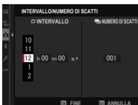
Se si utilizza un telecomando per scatto a distanza con il proprio timer, selezionare **CON TIMER ESTERNO**. Si tornerà alla visualizzazione di ripresa, in cui è possibile avviare le foto intervallate utilizzando il telecomando per scatto a distanza.
