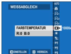
2 Bearbeiten Sie mit dem Fokushebel die Farbtemperatur und drücken Sie auf **MENU/OK**.
