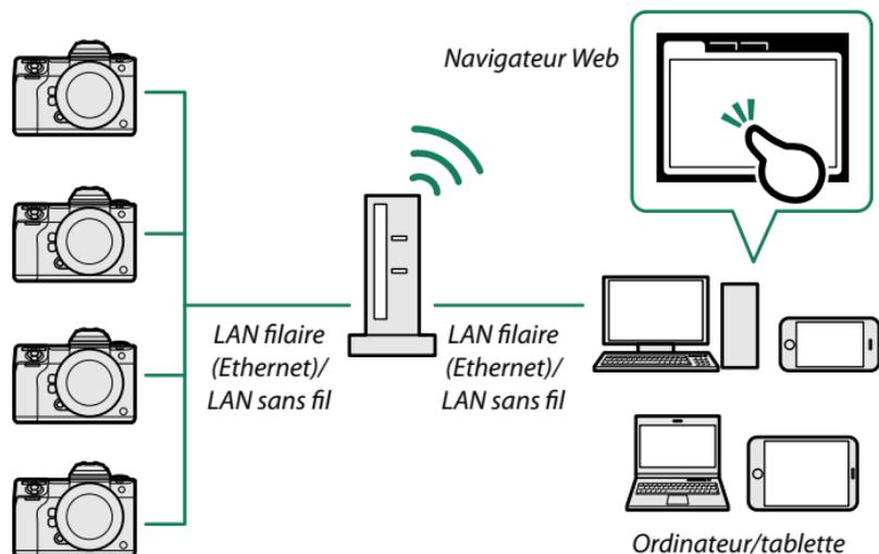
Avant d'enregistrer des films à distance, vous devez créer un profil de paramètres de connexion à utiliser lorsque vous connectez l'appareil photo à un ordinateur ou une tablette via un réseau LAN sans fil ou filaire.
