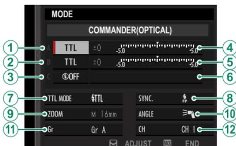
La télécommande de flash optique sans fil Fujifilm offre un choix de quatre canaux (canaux 1 à 4) pour l'échange de signaux optiques entre la télécommande et les flashes distants. Des canaux séparés peuvent être utilisés pour différents systèmes de flash ou pour éviter les interférences lorsque plusieurs systèmes fonctionnent à proximité.
