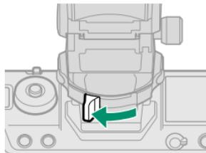
Avec le viseur dans la position souhaitée (①), remettez le verrou horizontal pivotant en position verrouillée (②) pour verrouiller le viseur en place.
