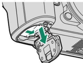
❗ La batterie peut chauffer lorsqu'elle est utilisée dans des environnements où la température est élevée. Faites attention lorsque vous retirez la batterie.
