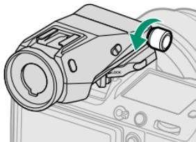
Avec le viseur dans la position souhaitée (①), serrez le bouton de verrouillage d'inclinaison (②) pour verrouiller le viseur en place.
