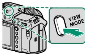
Utilisez **CONFIG. ÉCRAN > RÉGLAGE VIEW MODE** dans le menu de configuration afin de choisir un mode d'affichage pour le viseur électronique et pour l'écran LCD.
