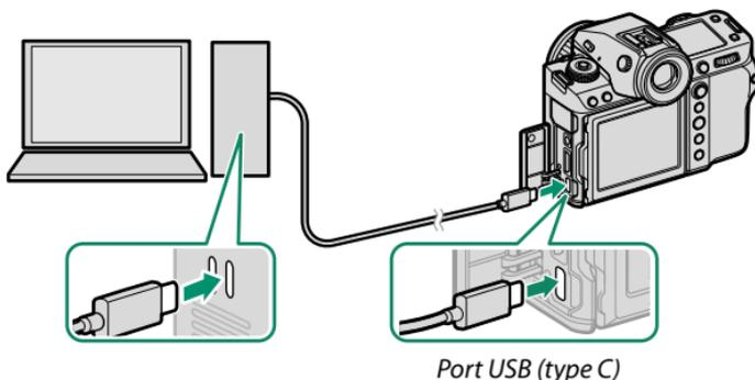
**!** Le câble USB ne doit pas dépasser 1 m (3,3 pi) et doit être adapté au transfert de données.
