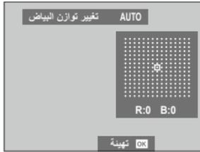
عند الضغط على **MENU/OK** بعد تحديد خيار توازن البياض، سيتم عرض مربع الحوار المبين على اليسار؛ استخدم زر الاختيار لضبط توازن البياض بدقة أو اضغط **DISP/BACK** للخروج دون الضبط الدقيق.
